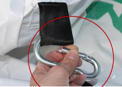
Erst, ein Paar Karabinerhaken montieren, um die Drahtseile und den Belüftungsschlauch zu verbinden.
