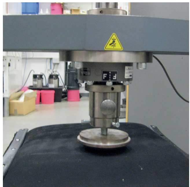
Bild 4: Messung der Verformbarkeit im Neuzustand
